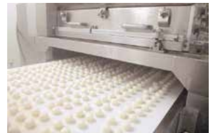
第二工場には世界初となる16列の団子生産ラインを導入。生産から包装までを担っている。
