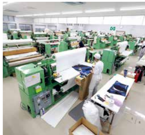
上) 原反を裁断後、洋服の形に縫い上げる縫製部門。多様な工業用ミシンを駆使し、顧客の要望通りに縫い上げる 下) 約40機ものマシンが並ぶプリント加工部門(マシンプリント)。専用のマシンを1人が1台担当し、布地にプリント加工を施していく。
