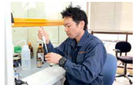
有機溶剤や粉じんなど有害なものを扱う作業場でサンプリングした空気などを測定する作業環境測定。
