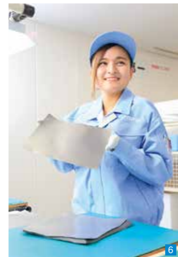
6 バスタレイドの外観検査、表面に異物がないかどうかを目視で検査。最終検査だけに慎重な判断が要求される。
